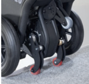
Sistema de brazos rotacional, con soporte de rueda ajustable en función de las diferentes alturas de escalón para aumentar la estabilidad y seguridad.
